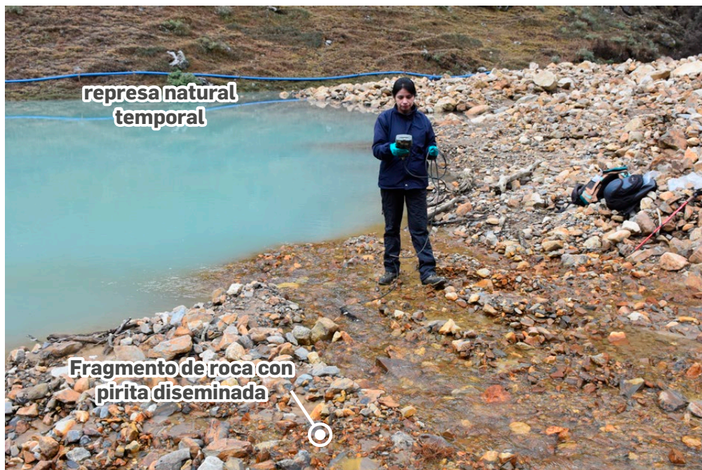
Figura 24. Sedimentación de fragmentos de roca con pirita diseminada proveniente de los flujos de detritos y acumulación de flujos de agua acidificada proveniente de la descarga de la laguna B.
