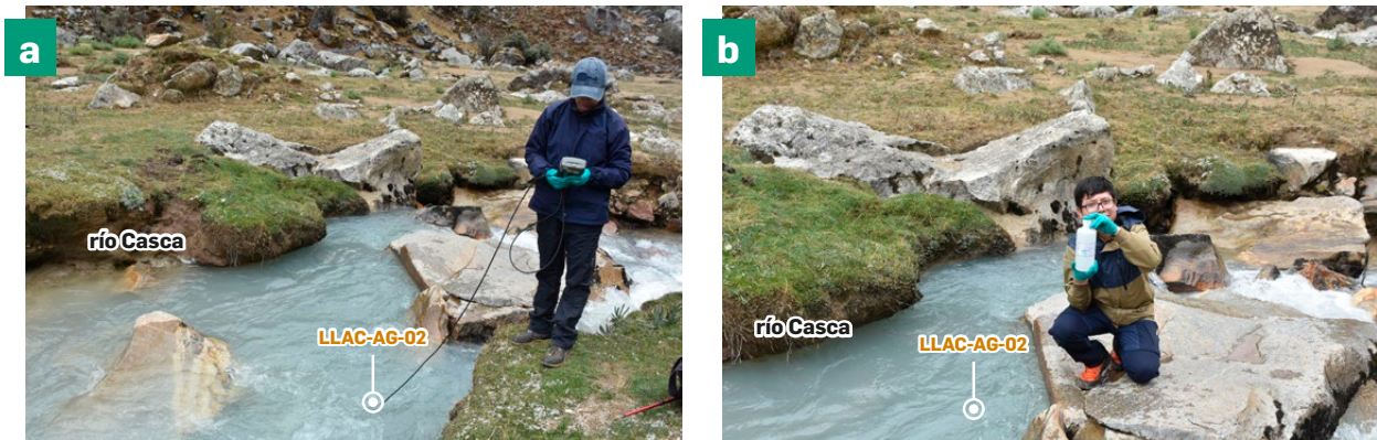
Figura 17. Cauce del río principal, punto de muestreo de agua. a) Imagen general del trayecto del cauce del río principal y evaluación de la calidad de agua con parámetros fisicoquímicas. b) Punto de extracción de muestra de agua.
