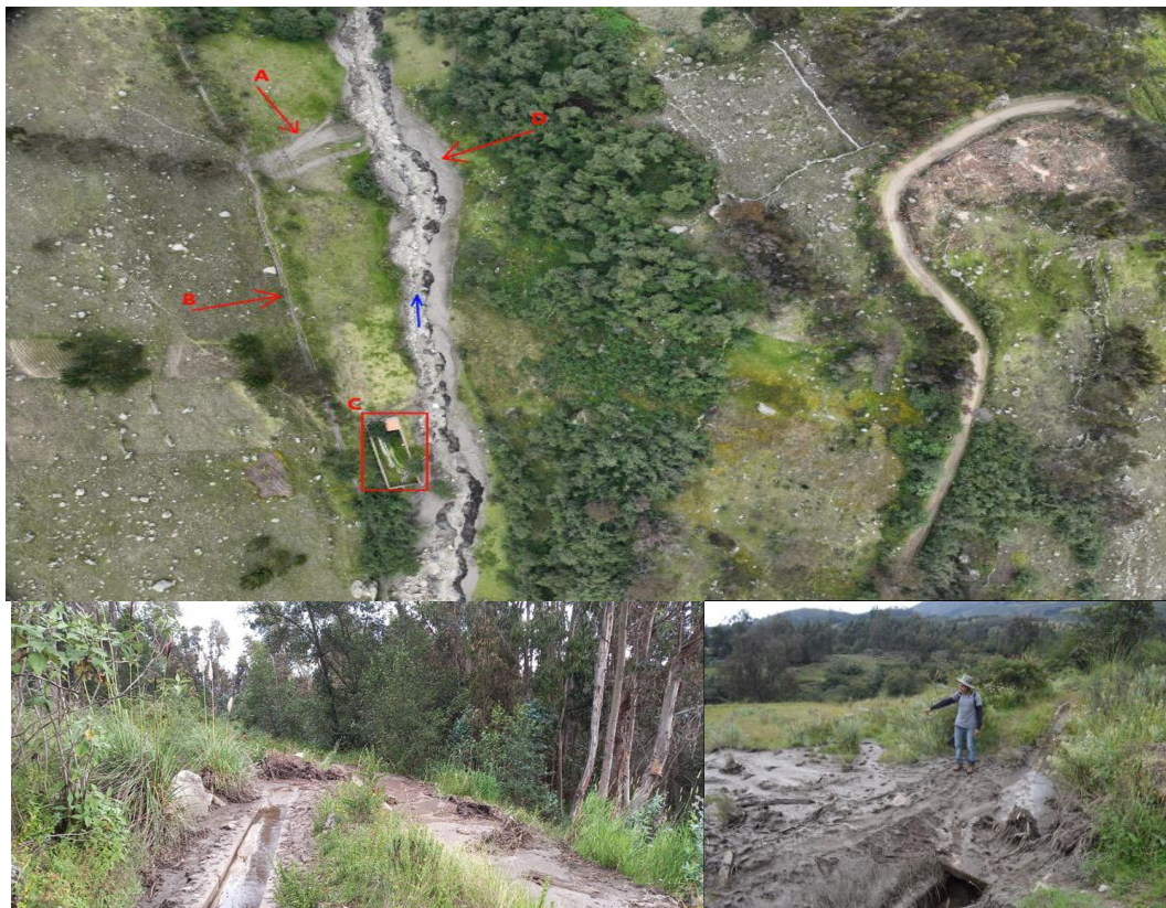
Figura 33. Afectaciones 4 y 5, Canal Cachipampa, canal de irrigación colmatado y rebasado con lodo, afectación de algunos campos de cultivo (colindante a la carretera Willcahuain - Llaca).
