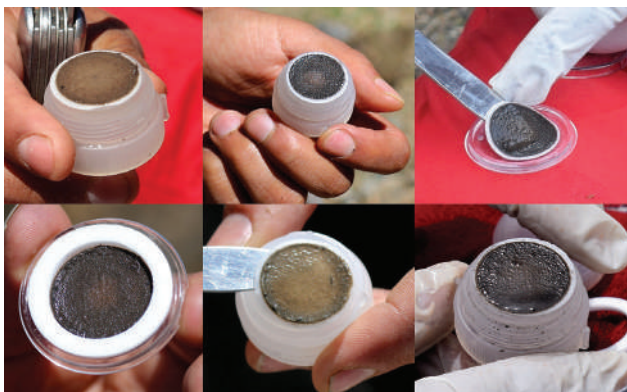
Figura 11. Filtros con distintas coloraciones debido a la presencia de diferentes LAPs. Foto: W. Sánchez.
