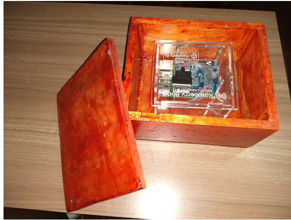
Figura 62: Caja de madera balsa, en cuyo interior se encuentra el sensor de infrasonido Raspberry Boom acoplado a un Raspberry Pi.
