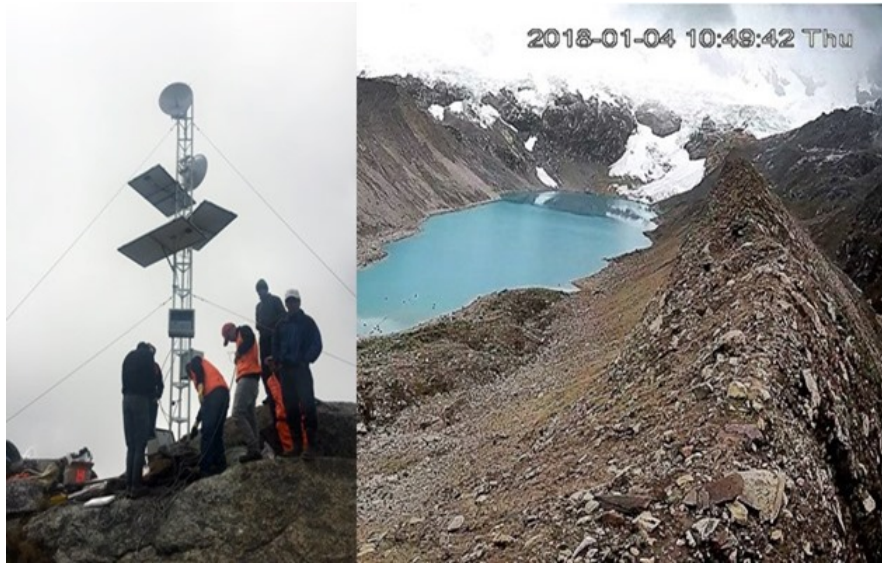
Figura 28: Izquierda: Sistema de monitoreo ubicado en la laguna Palcacocha. Derecha: Imágenes obtenidas por la cámara en tiempo real.
