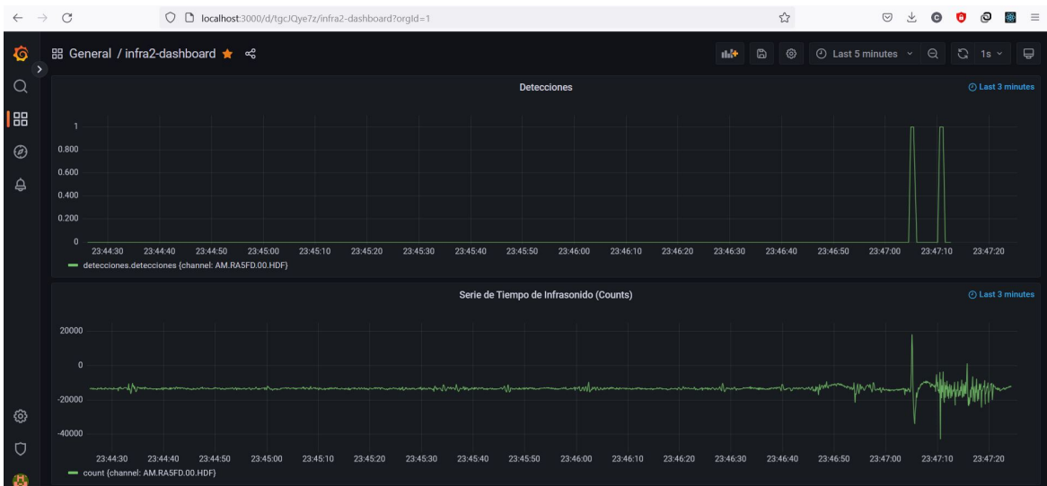
Figura 82: Dashboard de Grafana donde se pueden observar las gráficas configuradas: Los registros de detección y la señal de infrasonido, ambos se pueden observar en tiempo real.
