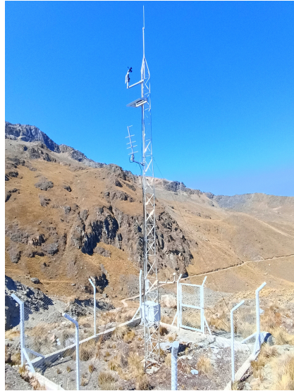
Figura 4.11: Estación Meteorológica Automática Huaytapallana - SE-NAMHI, la cual brinda información sobre temperatura, humedad relativa, precipitación, presión atmosférica y velocidad-dirección del viento
