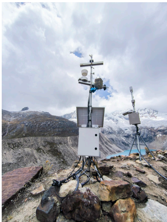
Figura 67. Ejemplo de sistema de monitoreo meteorológico en el entorno de una laguna peligrosa
