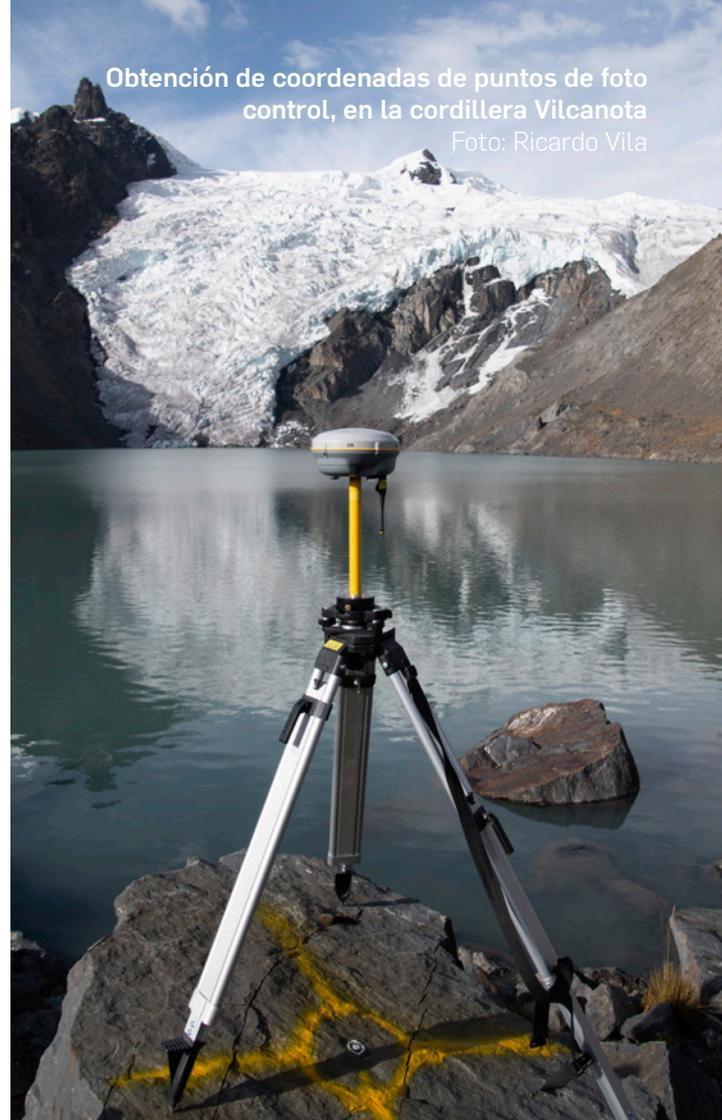
Obtención de coordenadas de puntos de foto control, en la cordillera Vilcanota
