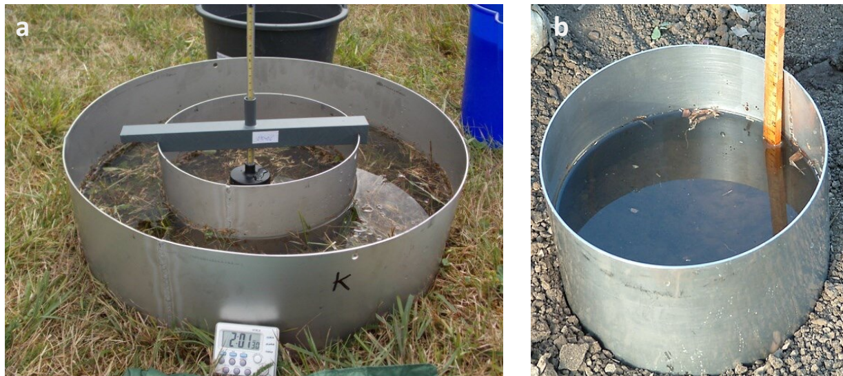
Figura 08. a) Infiltrómetro de doble anillo, b) Infiltrómetro de un anillo.
