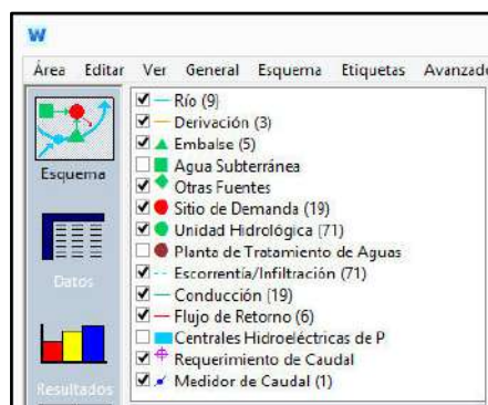
Figura 13. Componentes creados en el interfaz de WEAP.
