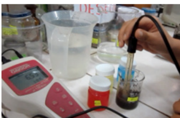
Figura 6. Se muestra el procedimiento seguido para el cálculo del pH de los suelos del bofedal piloto Chunal. En la imagen A se observa la media de la cantidad de 20 g, en B la medida de 20 ml del agua desmineralizada, C y D el procedimiento de agitación para formar la solución, en las imágenes E y F se muestra el procedimiento de calibración del potenciómetro y en la imagen G el cálculo del pH.
