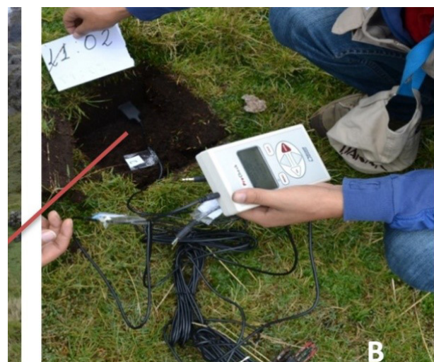
Figura 4. A) Se muestra los puntos en donde fueron medidos los parámetros de temperatura, conductividad eléctrica y el contenido volumétrico de agua en el suelo (humedad). B) Se muestra en detalle cómo fue medido cada punto con el equipo multiparámetro, a una profundidad de 15 cm.
