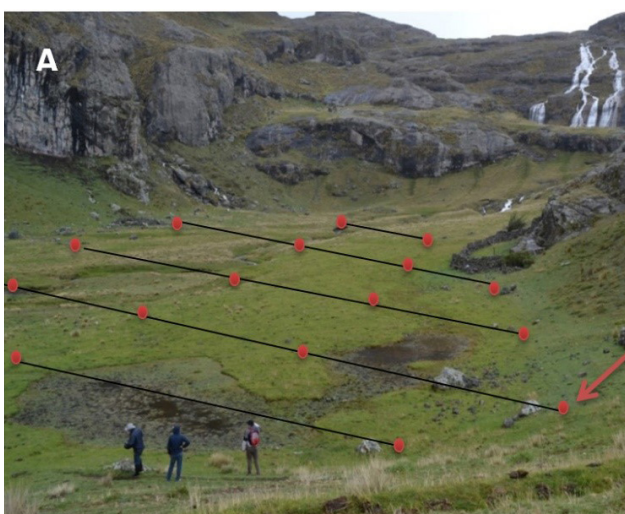
Figura 4. A) Se muestra los puntos en donde fueron medidos los parámetros de temperatura, conductividad eléctrica y el contenido volumétrico de agua en el suelo (humedad). B) Se muestra en detalle cómo fue medido cada punto con el equipo multiparámetro, a una profundidad de 15 cm.
