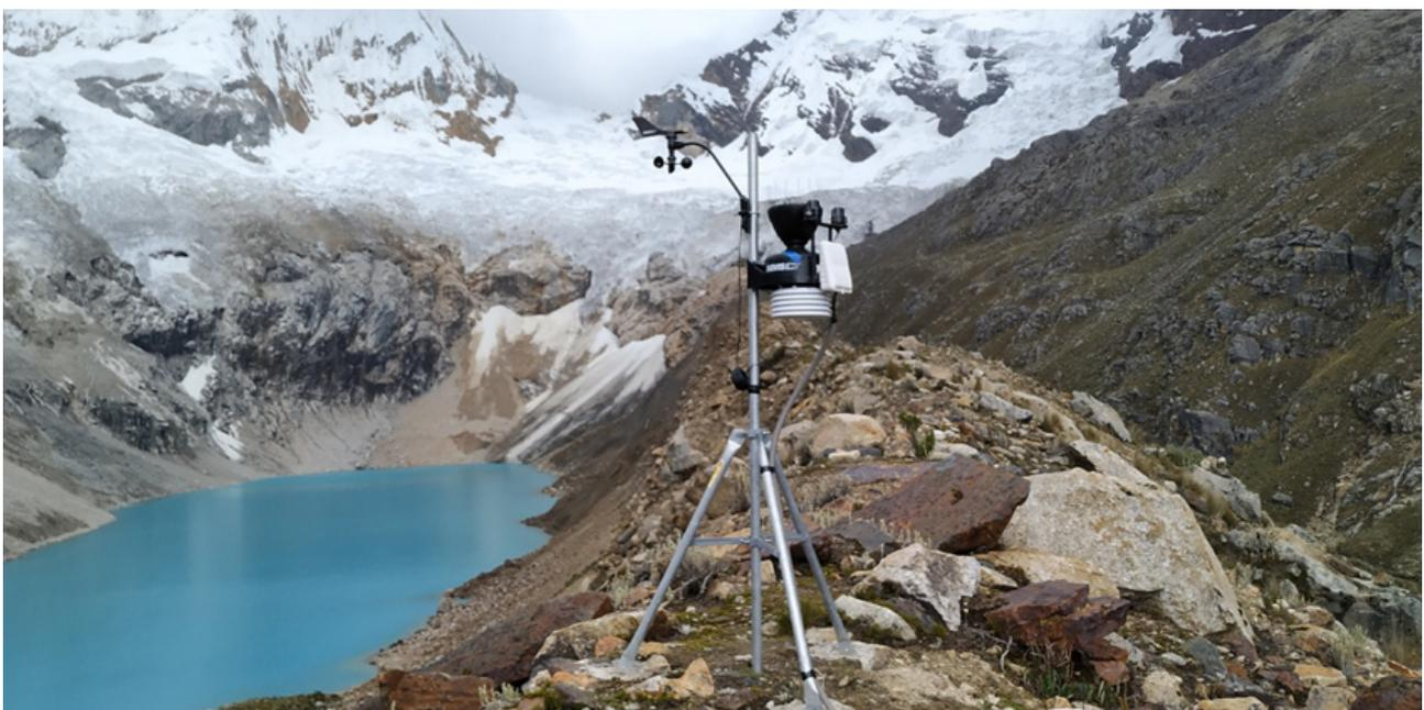
Figura 13. Estación meteorológica automática instalada en la morrena lateral de la laguna Palcacocha, Huaraz, Ancash.
