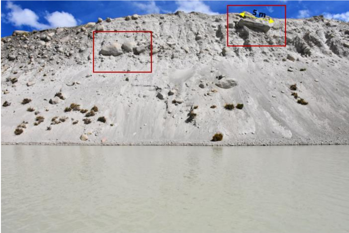
Figura 11. Flanco derecho, identificación de rocas con potencial a caídas y presencia de vegetación como indicador de estabilidad en los taludes (Foto del 18/06/2021, Vilca O.)
