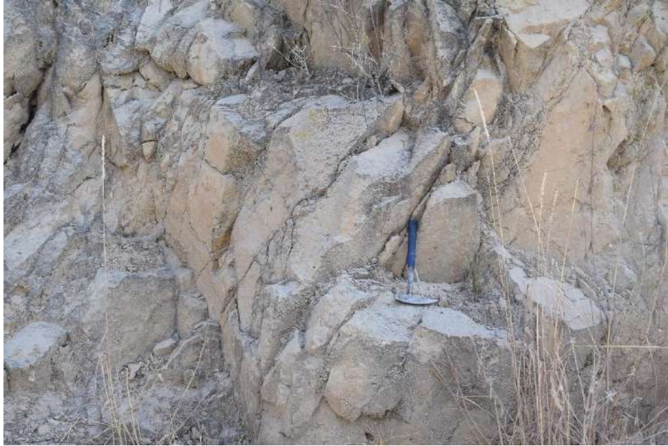
Figura 11. Suelos de resistencia media baja. Afloramiento rocoso del Volcánico Yungay, parte baja del río Lullán - Parón, donde se encontró tobas dacíticas ligeramente alteradas
