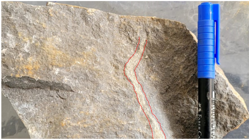
Figura 4. Muestra de roca corneana de protolito probable de arenisca cortada por venillas de pirita.
