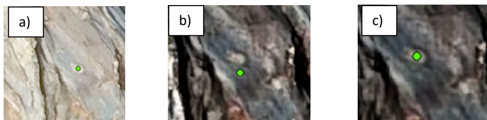
Figura 6. Georreferenciación de los productos fotogramétricos, en la figura a) s b) muestra la información del periodo 2024 donde se aprecia el desplazamiento del marcador verde evidenciando así el desplazamiento de la información, mientras que en la figura c) se muestra la información 2024 posicionado donde se aprecia el marcado verde correctamente ubicado.
