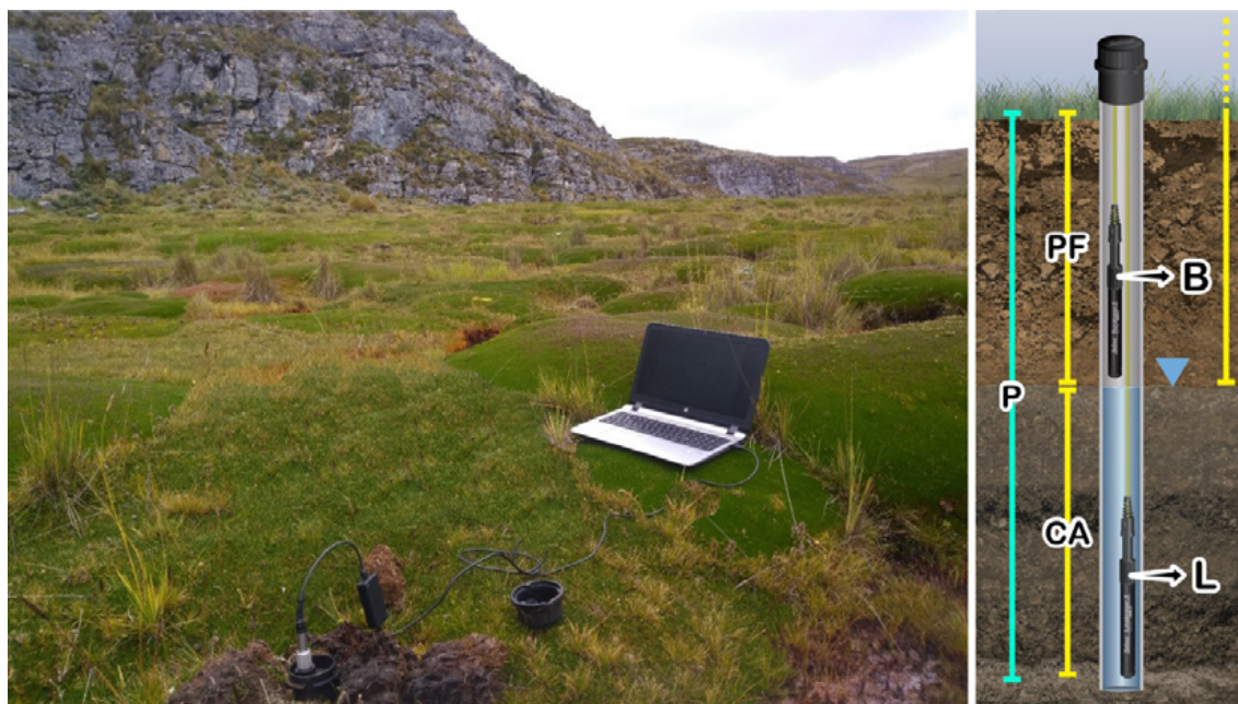
Figura 5. Variables de campo obtenidas de piezómetros Solinst
