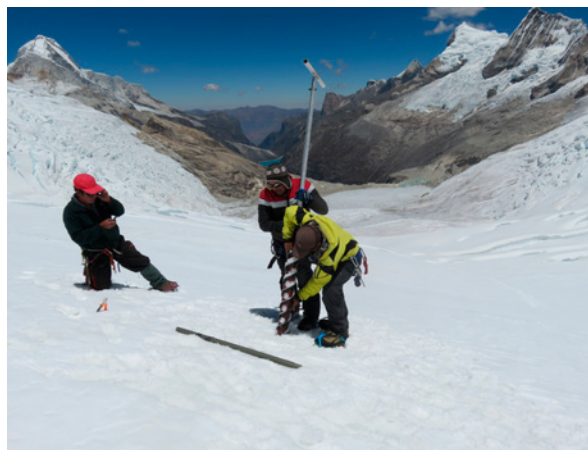
Figura 2. Capa de nieve acumulada durante un año hidrológico (izquierda) y perforación para extracción de muestras de neviza (derecha). Fotos: Área de Evaluación de Glaciares y Lagunas (RCE).
