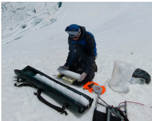
Figura 3. Medición de la densidad de neviza (izquierda) y ubicación de la capa basal (derecha). Fotos: Área de Evaluación de Glaciares y Lagunas (RCE).
