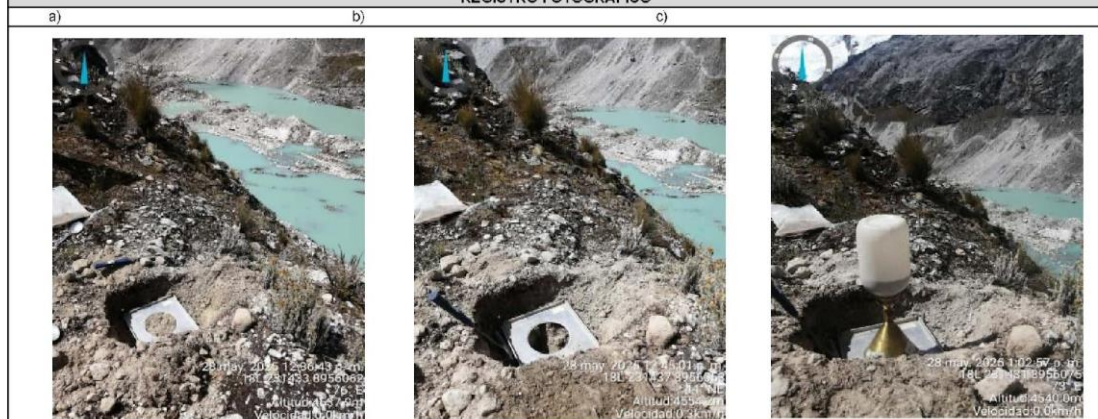
Fotografía: a) Preparación del suelo para la realización del ensayo in situ, b) Extracción de la muestra representativa de suelo, c) Realización del ensayo de densidad.
