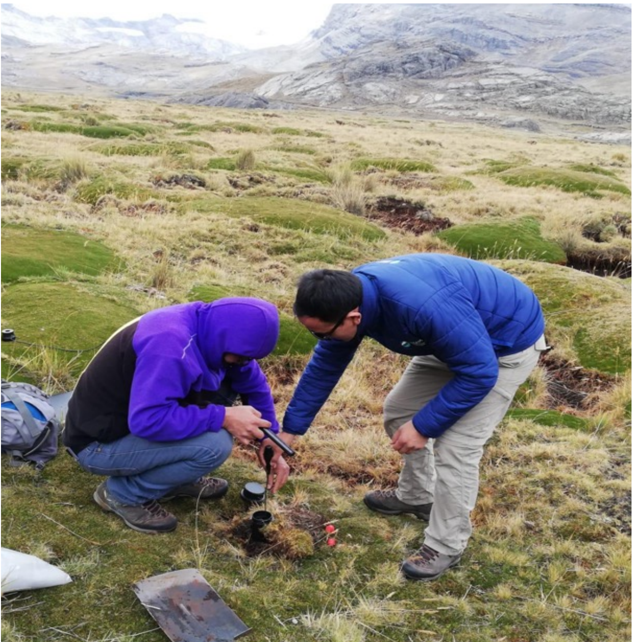
Figura 24. Instalación de sensor Levellogger en pozo de observación
