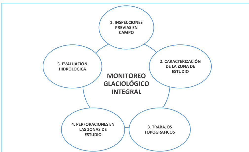
Figura N° 01: Esquema conceptual de la Fase de Campo en los trabajos de Monitoreo Glaciológico.
